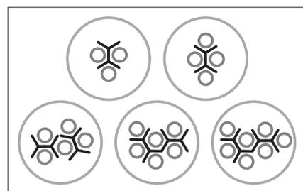
Для герметизации 3-х и более кабелей необходимо прокладывать между ними специальную герметизирующую вставку RDSS-Clip.
