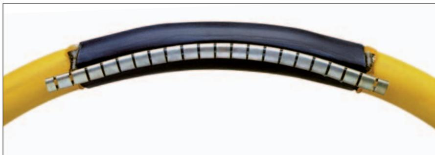
Нераспространяющие горение термоусаживаемые оборачиваемые манжеты MRSМ предназначены для быстрого и надежного ремонта поврежденных кабелей, использующихся в угледобывающей, строительной промышленности, на транспорте и других аналогичных применениях, где требуется негорючесть и сохранение гибкости. На внутренней поверхности манжет нанесен термоплавкий клей. Металлическую застежку после охлаждения можно удалить.
