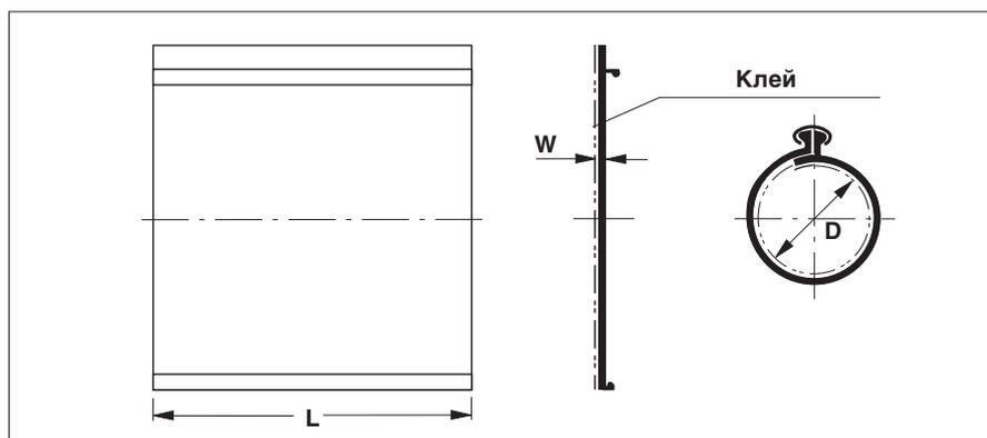
Галогено-чистые ремонтные оборачиваемые манжеты CRSM предназначены для быстрого и надежного ремонта поврежденных пластмассовых или металлических оболочек кабелей и восстанавливают электрическую и механическую целостность кабеля. На внутренней поверхности манжет нанесен термоплавкий клей.
