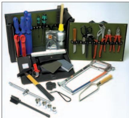
В комплект включен основной инструмент, используемый для разделки кабелей и монтажа кабельной арматуры.
