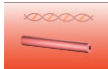
К нагретой трубке прикладывается давление и, таким образом, поперечно-сшитые молекулы растягиваются. На этой стадии требуется огромный опыт и обладание уникальными "ноу-хау" для того, чтобы контролировать продольную усадку и эксцентриситет трубки.
