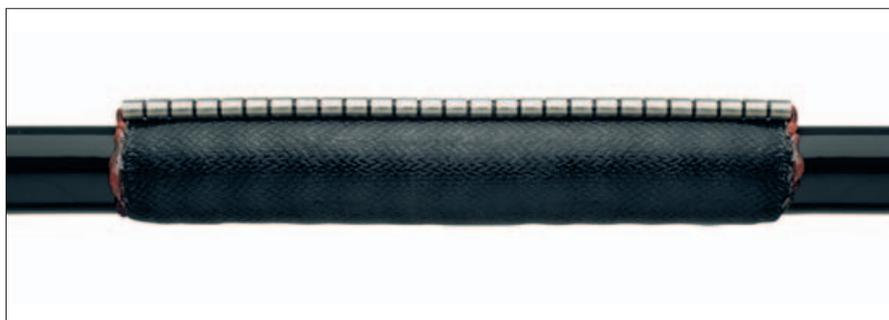
Армированные стекловолокном оборачиваемые манжеты RFSМ предназначены для быстрого и надежного ремонта кабелей и применяются там, где требуется повышенная механическая прочность. На внутренней поверхности манжеты нанесен термоплавкий клей.
