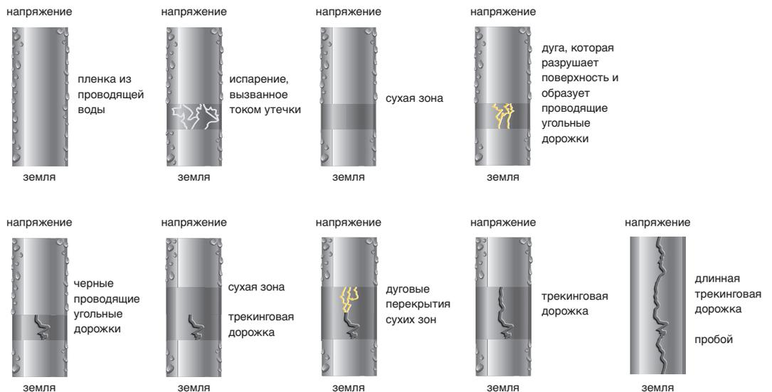
На рисунках показано возникновение трекинговых дорожек. При эрозии процесс разрушения идет вглубь материала.
