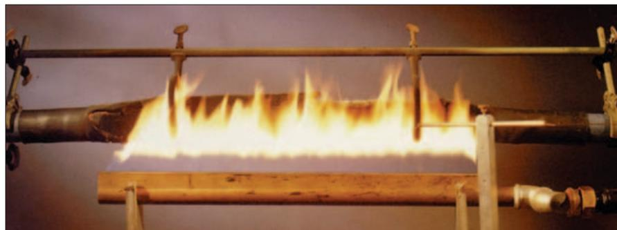
Муфта Raychem в огнестойком исполнении во время испытаний на работоспособность в течение 180 мин. в соответствии с IEC 60331.
