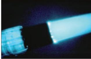
В кабельной арматуре Райхем применяются высококачественные изоляционные материалы и эффективные системы выравнивания НЭП, и как результат, уровень ЧР в муфтах не превышает 1 пКл. Для измерений ЧР требуется чувствительное оборудование, которое выделяет ЧР из шумового фона. ЧР не должны возникать при напряжении  $2xU_0$ . В наших лабораториях мы постоянно проводим испытания на ЧР при разработке и квалификации кабельной арматуры. Испытания проводятся до, во время и после циклических испытаний.
