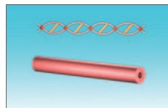
После сшивки следующим шагом по приданию трубке эластичной памяти является нагрев компаунда до температуры выше точки плавления кристаллитов. В этом состоянии молекулы удерживаются вместе только благодаря поперечным связям.
