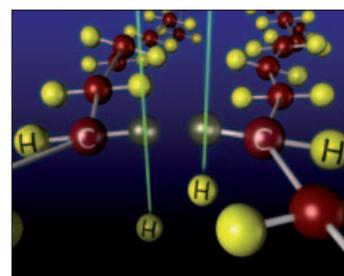
Если материал прошел процесс поперечной сшивки, он уже не будет плавиться или течь при повышении температуры. При нагреве кристалличность пропадает, как и прежде, но материал не потечет и не изменит формы, потому что поперечные связи действуют как стяжки между молекулами. В то же время поперечно-сшитая структура обладает эластичностью. Когда материал нагревается до температуры, при которой нарушается кристалличность, он становится резиноподобным.
