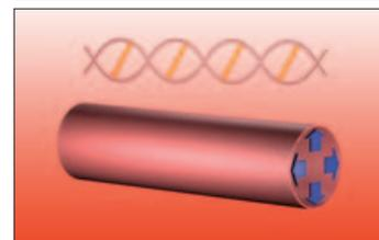
Трубка охлаждается в расширенном деформированном состоянии. Появляется кристалличность, которая закрепляет структуру материала в растянутом виде. Это та форма, в которой трубка поставляется заказчику. В таком виде трубка может храниться неограниченно долго.
