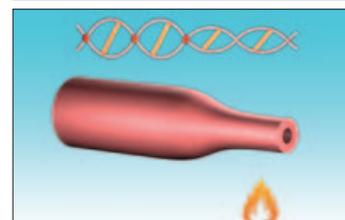
После охлаждения "кристаллы" фиксируют принятую после восстановления форму трубки.
