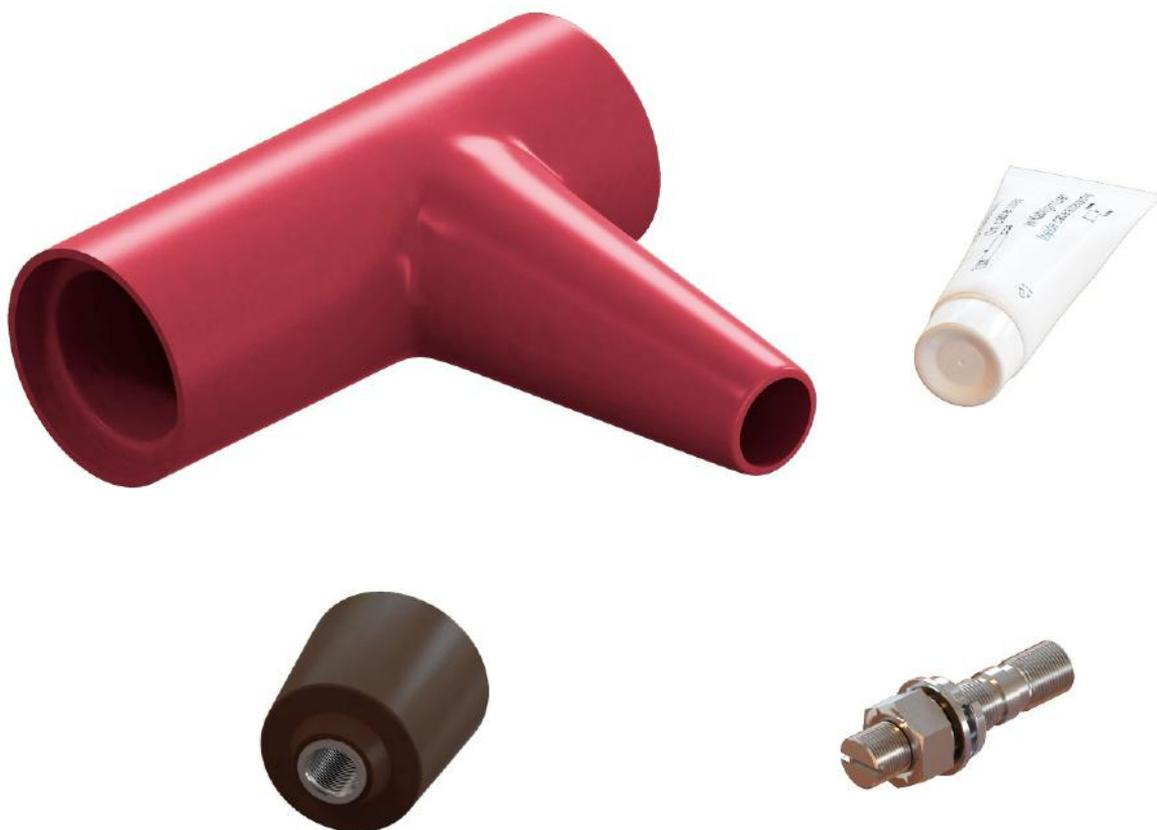
Изоляционный адаптер предназначен для подключения КЛ к бушингу тип С элегазовых ячеек распределительных устройств до 20кВ. Адаптер обеспечивает надежную изоляцию и совместим со всеми концевыми муфтами «КАМА». Эластомерный материал из которого сделан адаптер позволяет многократное его использование. Температура эксплуатации от +50 до -50°С, а также при относительной влажности до 98% при температуре до 35°С.
