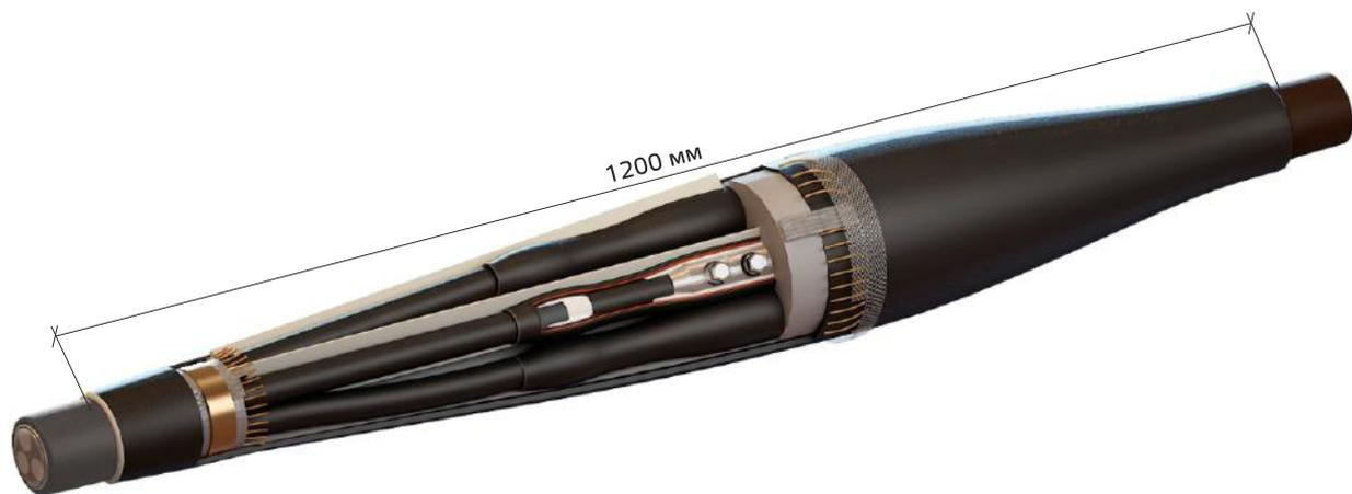
Муфты соединительные-переходные термоусаживаемые типа ЗСПТП-10 предназначены для соединения 3-х жильного кабеля с СПЭ-изоляцией с 3-х жильным кабелем с бумажно-пропитанной изоляцией, с бронелентами или без них, на напряжение 6/10кВ, частотой 50Гц. Муфты эксплуатируются при температуре окружающей среды от +50 до -50°С, а также при относительной влажности до 98% при температуре до 35°С. Муфты соответствуют ГОСТ 13781.0-86, СТО 00081866-001-2009, ТУ 3599-001-60707993-2009.
