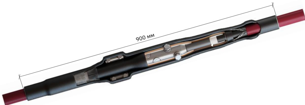
Муфты соединительные термоусаживаемые типа 1ПСТО-10 предназначены для соединения одно-жильных кабелей на напряжение 6/10кВ, частотой 50Гц, с СПЭ-изоляцией, с алюминиевым экраном, с алюминиевыми или медными жилами сечением от 25 до 800мм<sup>2</sup> типа: ПвП, АпвП, ПвПу, АпвПу, ПвПг, ПвПуг, ПвПу2г АпвПг, АпвПуг, АпвКсП, ПвКсП, АпвКсВ, ПвКсВ и т.д.
