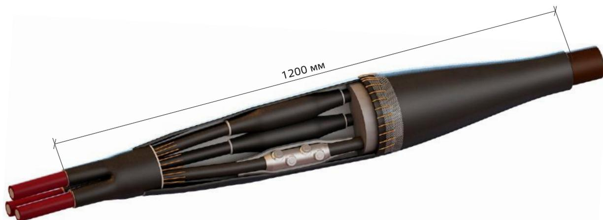
Муфты соединительные-переходные термоусаживаемые типа ЗПСТП-10 предназначены для соединения 3-х одножильных кабелей с СПЭ-изоляцией с одним 3-х жильным кабелем с бумажной маслопропитанной изоляцией, с бронелентами или без них, на напряжение 6/10кВ, частотой 50Гц. Муфты эксплуатируются при температуре окружающей среды от +50 до -50°С, а также при относительной влажности до 98% при температуре до 35°С. Муфты соответствуют ГОСТ 13781.0-86, СТО 00081866-001-2009, ТУ 3599-001-60707993-2009.
