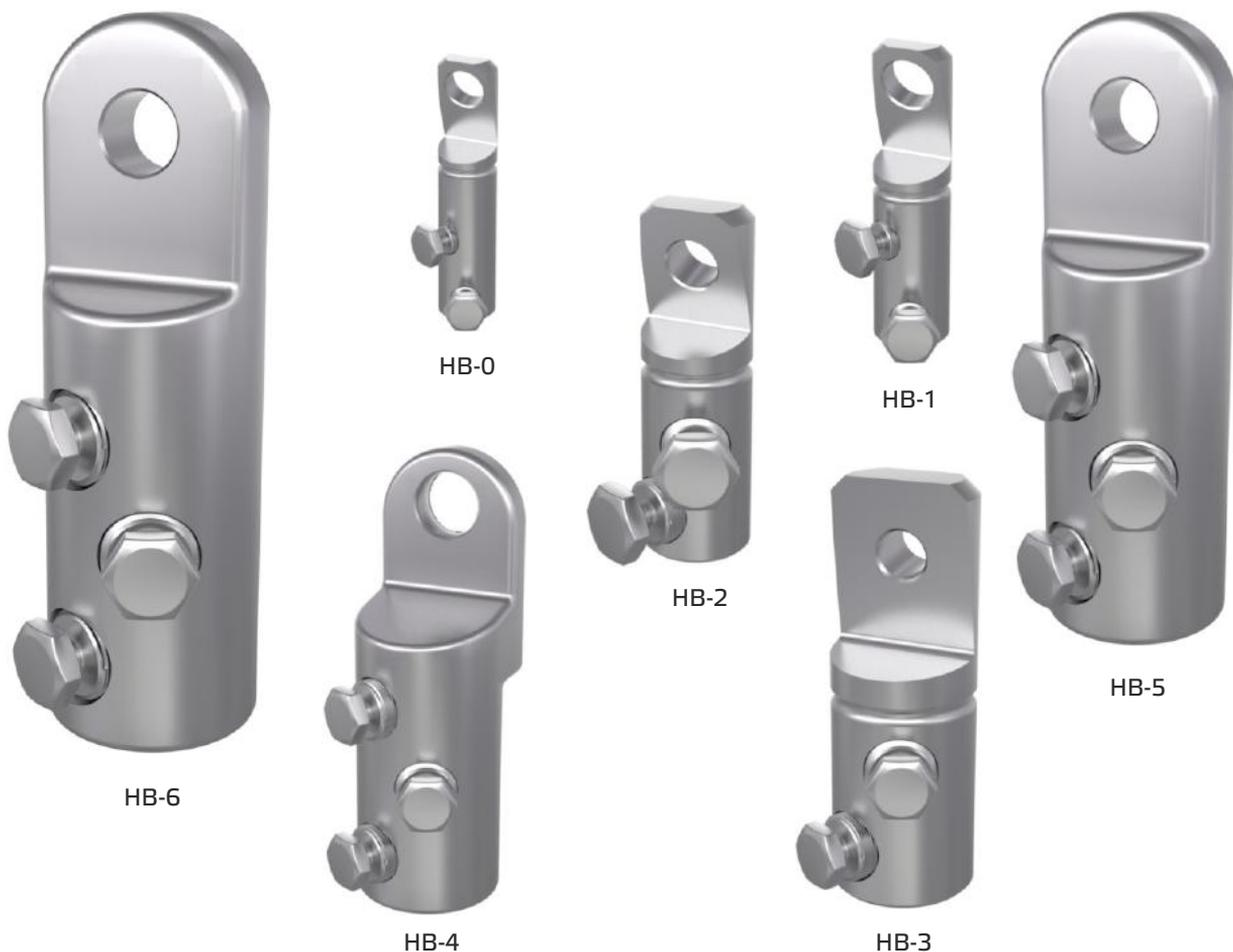
Наконечники винтовые со срывными головками предназначены для оконцевания жил кабелей до 10кВ. Универсальные размеры позволяют использовать один тип наконечника на разных сечениях жил кабелей. Наконечники изготовлены из специального алюминиевого сплава. Дополнительно наконечники могут быть подвержены гальваническому лужению поверхности.
